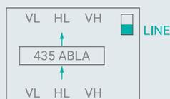
In tutti i modelli della serie non c'è prelievo di alimentazione dalla **linea HH**: questa porta Satellite viene utilizzata per far passare una corrente in modo **diretto**, senza alcun assorbimento da parte dell'amplificatore, ad esempio per alimentare l'LNB utilizzando un alimentatore dedicato alla base dell'impianto.
