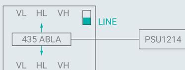
**Alimentazione da linee Satellite passanti VL, HL o VH:** questo è il tipico caso di amplificatore di **linea**, il prodotto viene interamente alimentato dalle linee Satellite e **passa la tensione** verso le porte di ingresso, per alimentare un eventuale LNB, senza alcuna limitazione di corrente per non interferire con l'impianto esistente; in questa configurazione il dip switch deve essere posizionato in **modalità LINE**.
