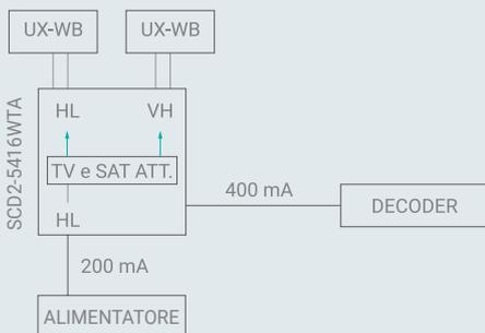
**3 - Alimentazione da solo decoder:** questa modalità si attiva quando non c'è una tensione sul connettore DC-IN o su linea VL ed è utile per **limitare il carico del multiswitch sulla dorsale** oppure quando non c'è la possibilità di portare una tensione al piano; in questo caso:
