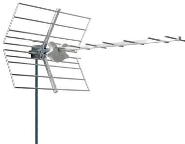
Antenne Yagi de **bande UHF** avec connecteur F.**Distribution géométrique** des éléments **redessinée** pour mieux filtrer les interférences LTE.**Excellente robustesse** **mécanique** grâce à l'utilisation des tubes en aluminium de 8mm.**UFiltre LTE** intégré dans le dipôle.**Spécifications techniques**
