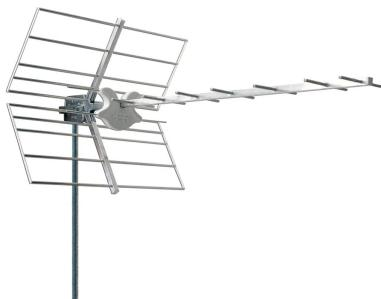
Antena Yagi en banda UHF con conector F y doble filtrado, que combina la selección de frecuencias 5G y 4G LTE proporcionada por la geometría del elemento con el filtro 5G integrado en el dipolo del radiador. Reflectores de cortina (tubo pequeño).
