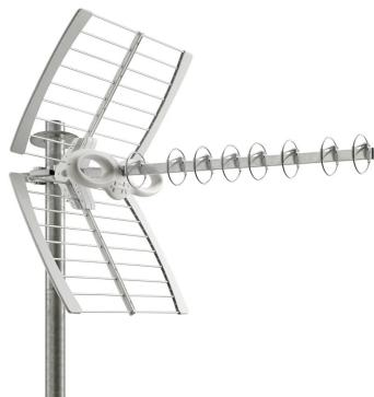
Antenne Loop Yagi de **bande UHF** avec connecteur F. Eléments prémontés, dipôle et réflecteurs à insertion rapide et fixation au mât avec réglage vertical de série avec **vis papillon** pour le montage **sans outils**.
