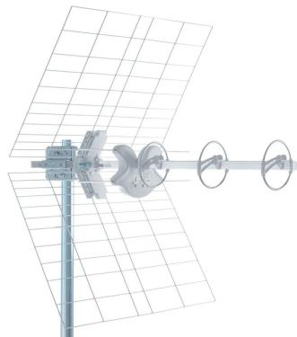
Antenne Loop Yagi de **bande UHF** avec connecteur F. Eléments prémontés, dipôle et réflecteurs à insertion rapide et fixation au mât avec réglage vertical de série avec **vis papillon** pour le montage **sans outils**.
