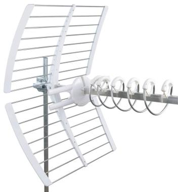
Antenne **héliçoïdale** de **bande UHF** avec connecteur F, continuité de la technologie Loop Yagi adoptée par Fracarro .Eléments prémontés, dipôle et réflecteurs à insertion rapide et fixation au mât avec réglage vertical de série avec **vis papillon** pour le montage **sans outils**.
