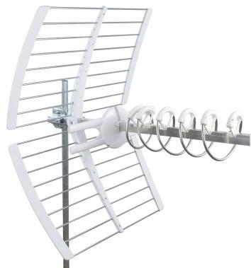
Antenna **attiva elicoidale di banda UHF** con connettore F, in continuità con la tecnologia Loop Yagi adottata da Fracarro; LED di monitoraggio, controllo automatico del segnale di ingresso (CAG) e filtro 5G e 4G LTE integrato e imballo singolo in sacchetto
