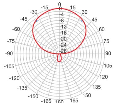
**Ganancia (x: frecuencia MHz, y: ganancia ISO dBi) y diagrama de radiación (@600MHz)**
