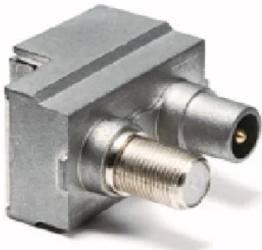
Conector tipo resorte con atenuación de 14dB; 2 salidas desmixtas con conector IEC macho para la banda de TV (47-862MHz) y conector F hembra para la banda de Satélite (950-2400MHz)
