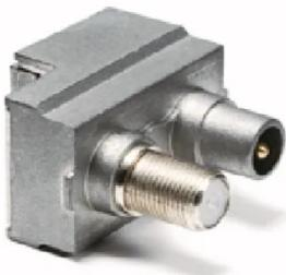
**Presa frutto derivata** con attenuazione 22dB; **2 uscite demiscelate** con connettore IEC maschio per la banda TV (47-862MHz) e connettore F femmina per la banda Satellite (950-2400MHz)
