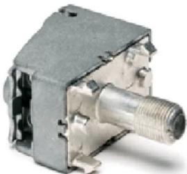
Prise de fruit dérivée avec atténuation de 10dB ; 1 sortie avec connecteur femelle F dans la bande TV et Satellite (5-2400MHz).
