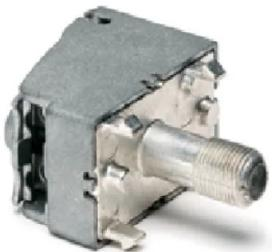
Presa frutto derivata con attenuazione 18dB; 1 uscita con connettore F femmina in banda TV e Satellite (5-2400MHz).
