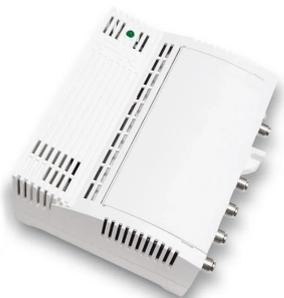
Centralino di linea con 1 ingresso a larga banda (III+DAB+UHF) da interno autoalimentato con guadagno 21dB e livello di uscita fino a **124dB $\mu$ V**, regolazione del guadagno (0-20dB) e bassa figura di rumore.
