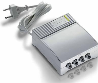
Amplificador de interior autoamplificado de 1 entrada (VHF+UHF) con RC y 2 salidas con ganancia de 20dB y nivel de salida hasta 108dB $\mu$ V en banda UHF, ajustes de nivel (15dB) y baja figura de ruido.
