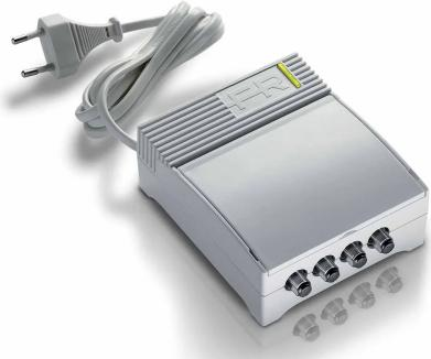
Amplificador de interior autoamplificado de 1 entrada (VHF+UHF) y 2 salidas con ganancia de 30dB y nivel de salida hasta 106dB $\mu$ V en banda UHF, ajustes de nivel independientes (15/20 dB) para cada banda y baja figura de ruido.
