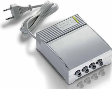
Amplificateur pour intérieur autoalimenté avec 1 entrée (VHF+UHF) et 2 sorties avec un gain de 30dB et niveau de sortie jusqu'à **106dB $\mu$ V** dans la bande UHF, réglage du gain (15/20dB) indépendant pour chaque bande et faible facteur de bruit.
