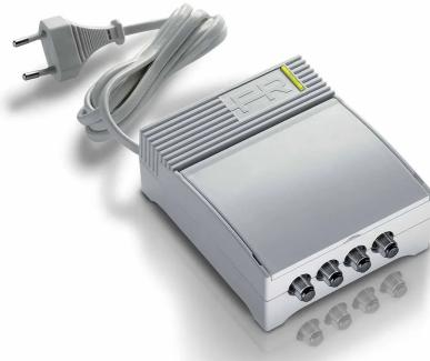
**Amplificador autoamplificado de interior con 1 entrada (VHF+UHF+SAT)** con ganancia de 30dB y nivel de salida hasta **100dB $\mu$ V**, ajustes independientes de nivel de TV y SAT (20dB) y baja figura de ruido.
