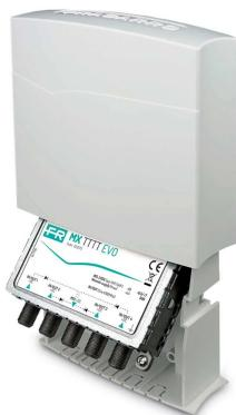
Mezclador y repartidor de mástil de 3 entradas (FM+III+DAB, UHF, UHF) para mezclar señales de múltiples antenas. Paso de CC en el segundo puerto de banda UHF.
