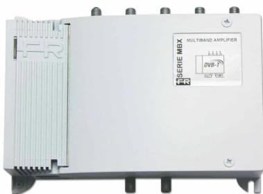
**Centralita autoalimentada de interior con 2 entradas (RC+FM+VHF+UHF, SAT)** con ganancia de 37-43dB y nivel de salida hasta **120dB $\mu$ V** en banda SAT, ajuste de ganancia (15dB) y baja figura de ruido.
