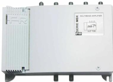
Centralino con 2 ingressi (RC+FM+VHF+UHF, SAT) autoalimentata da interno con guadagno 37-43dB e livello di uscita fino a 120dB $\mu$ V in banda SAT, regolazione del guadagno (15dB) e bassa figura di rumore.
