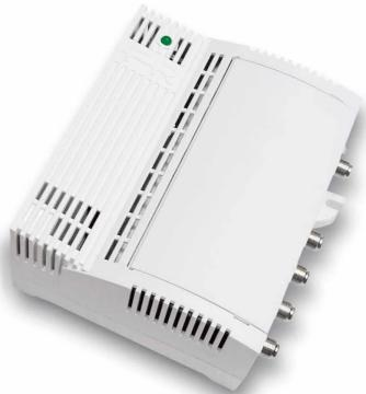
Amplificateurs multi-entrées auto-alimentés pour amplifier et coupler le signal provenant de plusieurs antennes. Disponible en deux versions, une à 118/120dB $\mu$ V et une à 123dB $\mu$ V de sortie, pour répondre à tous les besoins d'installation de petite et moyenne taille. Ils disposent d'un châssis métallique entièrement blindé avec connecteurs F et boîtier en plastique blanc.
