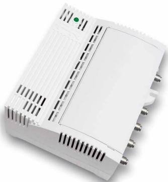
Centralino multingresso da interno autoalimentato per amplificare e miscelare il segnale proveniente da diverse antenne. Disponibili in due versioni, una a 118/120dB $\mu$ V e una a 123dB $\mu$ V, per soddisfare tutte le esigenze installative di impianti di piccole-medie dimensioni. Sono dotati di telaio in metallo completamente schermato con connettori F. Filtro 790MHz 4G LTE integrato.
