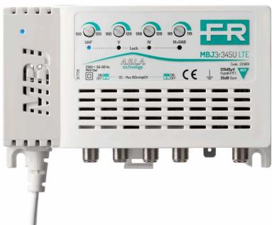
Centralino con 4 ingressi (III+DAB, IV, V, UHF) da interno autoalimentato con guadagno 35dB e livello di uscita fino a 120dB $\mu$ V in banda UHF, amplificazioni separate, regolazioni del livello (20dB) indipendenti per ogni ingresso e bassa figura di rumore. Filtro 4G LTE 790MHz integrato.
