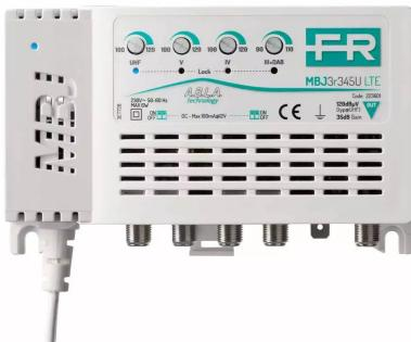
Centralino con 4 ingressi (III+DAB, IV, V, UHF) da interno autoalimentato con guadagno 20dB e livello di uscita fino a 115dB $\mu$ V in banda UHF, amplificazioni separate, regolazioni del livello (20dB) indipendenti per ogni ingresso e bassa figura di rumore. Filtro 4G LTE 790MHz integrato.
