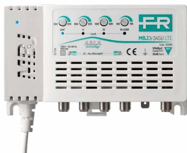
Centralino con 4 ingressi (III+DAB, IV, V, UHF) da interno autoalimentato con guadagno 20dB e livello di uscita fino a 115dB $\mu$ V in banda UHF, amplificazioni separate, regolazioni del livello (20dB) indipendenti per ogni ingresso e bassa figura di rumore. Taratura speciale nelle frequenze di taglio tra banda IV e banda V e filtro 4G LTE 790MHz integrato.
