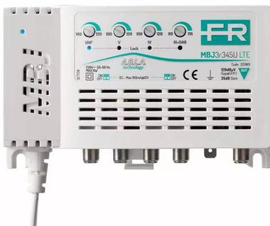
**Centralino con 3 ingressi (FM+III+DAB, UHF, UHF) da interno autoalimentato con guadagno 20dB e livello di uscita fino a 115dBrV in banda UHF, amplificazioni separate, regolazioni del livello (20dB) indipendenti per ogni ingresso e bassa figura di rumore. Filtro 4G LTE 790MHz integrato.**
