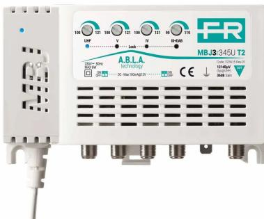
**Centralita autoamplificada de interior de 4 entradas (III+DAB, IV, V, UHF) con 35dB de ganancia y nivel de salida hasta 120dB $\mu$ V en la banda UHF, amplificación independiente, ajustes de nivel independientes (20dB) para cada entrada y baja figura de ruido. Tecnología T2 con filtro integrado para eliminar interferencias 5G a 694MHz.**
