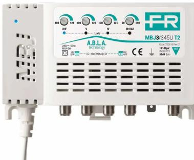
Amplificateur pour intérieur auto-alimenté à 1 entrée (III+DAB+IV+V) avec un gain de 25dB et un niveau de sortie jusqu'à 115dB $\mu$ V dans la bande UHF, amplification séparée des bandes, réglage du niveau indépendant (20dB) pour chaque bande et faible facteur de bruit. Technologie T2 avec filtre intégré pour éliminer les interférences 5G à 694MHz.
