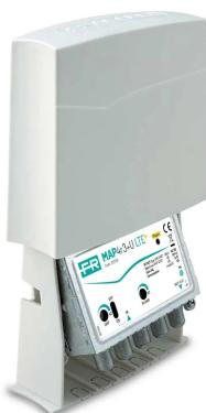
Amplificatore con 4 ingressi (III+DAB, IV, V, UHF) da palo con guadagno 25dB e livello di uscita fino a 116dB $\mu$ V in banda UHF, amplificazioni separate VHF/UHF, regolazioni del guadagno (0-15dB) indipendenti per ogni ingresso e bassa figura di rumore. Taratura speciale nelle frequenze di taglio tra banda IV e banda V; filtro 4G LTE 790MHz integrato.
