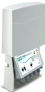
Amplificador de mástil con 4 entradas (FM, III+DAB, UHF, SAT) con ganancia de 25dB y nivel de salida hasta 116dB $\mu$ V en la banda UHF, amplificación separada VHF/UHF, ajustes de ganancia independientes (0-15dB) para cada entrada y baja figura de ruido.
