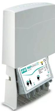
Amplificador de mástil con 2 entradas (III+DAB, UHF) con ganancia de 21 dB y nivel de salida de hasta 110 dB $\mu$ V en la banda VHF, UHF totalmente pasivo con paso de CC para alimentar ELIKA PRO. Filtro 4G LTE de 790 MHz integrado.
