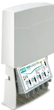
**Amplificateur de mât avec 4 entrées (III+DAB, IV, V, UHF) avec un gain de 40dB et niveau de sortie jusqu'à 110dB $\mu$ V ou 120dB $\mu$ V sélectionnable en bande UHF, amplifications séparées VHF/UHF, réglage du gain (0-15 dB) indépendant pour chaque entrée et faible facteur de bruit. Étalonnage spécial des fréquences de coupure entre la bande IV et la bande. Filtre 790 MHz 4G intégré.**
