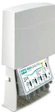
Amplificateur de mât avec 3 entrées (III+DAB, UHF, UHF) avec un gain de 40dB et niveau de sortie jusqu'à 110dB $\mu$ V ou 120dB $\mu$ V sélectionnable en bande UHF, amplifications séparées VHF/UHF, réglage du gain (0-15 dB) indépendant pour chaque entrée et faible facteur de bruit. Filtre 790 MHz 4G intégré.
