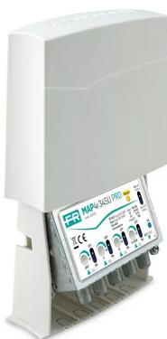
Amplificatore con 1 ingresso (III+DAB+IV+V) da palo con guadagno 41dB e livello di uscita fino a 110dB $\mu$ V o 120dB $\mu$ V in banda UHF selezionabile, amplificazioni separate VHF/UHF, regolazioni del guadagno (0-15dB) indipendenti per ogni banda e bassa figura di rumore. **Filtro 4G LTE 790MHz integrato.**
