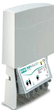
Amplificador de mástil de 1 entrada (UHF) con ganancia de 30 dB y nivel de salida de hasta 118 dB $\mu$ V en la banda UHF, ajuste de ganancia de 0 a 15 dB y baja figura de ruido. Filtro LTE 5G y 4G de 694 MHz integrado.
