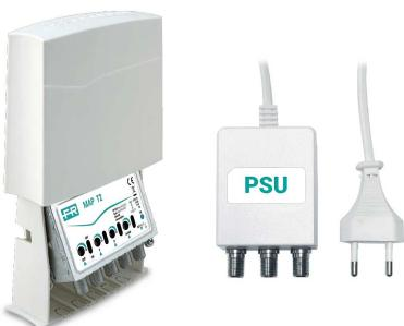
**Amplificatore con 1 ingresso (III+DAB+UHF) da palo con guadagno 25dB e livello di uscita fino a 116dB $\mu$ V in banda UHF, amplificazioni separate VHF/UHF, regolazioni del guadagno (0-15dB) indipendenti per ogni banda e bassa figura di rumore. Tecnologia T2 con filtro integrato per eliminare le interferenze 5G a 694MHz.**
