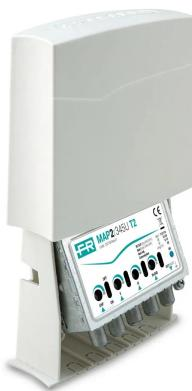
Amplificador de mástil con 4 entradas (III+DAB, IV, V, UHF) con ganancia de 25dB y nivel de salida hasta 116dB $\mu$ V en la banda UHF, amplificación separada VHF/UHF, ajustes de ganancia independientes (0-15dB) para cada entrada y baja figura de ruido. Tecnología T2 con filtro integrado para eliminar interferencias 5G a 694MHz.
