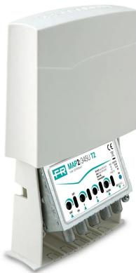
Amplificador de mástil con 4 entradas (III+DAB, IV, V, UHF) con ganancia de 25dB y nivel de salida hasta 116dB<sub>V</sub> en la banda UHF, amplificación separada VHF/UHF, ajustes de ganancia independientes (0-15dB) para cada entrada y baja figura de ruido. Tecnología T2 con filtro integrado para eliminar interferencias 5G a 694MHz.
