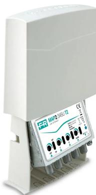
Amplificador de mástil con 4 entradas (III+DAB, IV, V, UHF) con ganancia de 25 dB y nivel de salida de hasta 116 dB $\mu$ V en la banda UHF, amplificación independiente VHF/UHF, ajustes de ganancia independientes (0-15 dB) para cada entrada y baja figura de ruido. Calibración especial en las frecuencias de corte entre las bandas IV y V y tecnología T2 con filtro integrado para eliminar interferencias 5G a 694 MHz.
