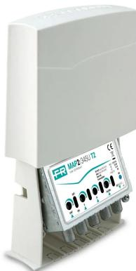
Amplificateur de mât à 4 entrées (III+DAB, IV, V, UHF) avec gain de 25dB et niveau de sortie jusqu'à **116dB<sub>P</sub>V dans la bande UHF**, amplification VHF/UHF séparée, réglage indépendant du gain (0-15dB) pour chaque entrée et faible facteur de bruit. **Calibrage spécial** dans les fréquences de coupure entre la bande IV et la bande V et **technologie T2** avec filtre intégré pour éliminer les interférences 5G à 694MHz.
