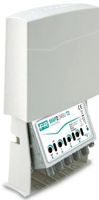
**Amplificateur de mât avec 1 entrée (II+DAB+UHF)**, un gain de 25dB et niveau de sortie maximum de **116dB $\mu$ V en UHF**, amplifications séparées VHF/UHF, réglage du gain 0-15dB pour chaque bande et faible facteur de bruit. **Technologie T2** avec filtre intégré contre les interférences 5G à 694MHz.
