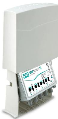
Amplificador de mástil de 3 entradas (III+DAB, UHF, UHF) con ganancia de 28dB y nivel de salida hasta 116dB $\mu$ V en la banda UHF, amplificación separada VHF/UHF, ajustes de ganancia independientes (0-15dB) para cada entrada y baja figura de ruido. Tecnología T2 con filtro integrado para eliminar interferencias 5G a 694MHz.
