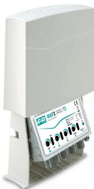
Amplificador de mástil con 4 entradas (III+DAB, IV, V, UHF) con ganancia de 25dB y nivel de salida hasta 116dB<sub>u</sub>V en la banda UHF, amplificación separada VHF/UHF, ajustes de ganancia independientes (0-15dB) para cada entrada y baja figura de ruido. Tecnología T2 con filtro integrado para eliminar interferencias 5G a 694MHz.
