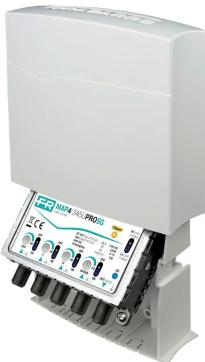
Amplificador de mástil con 4 entradas (III+DAB, IV, V, UHF) con ganancia de 40 dB y nivel de salida de hasta 110 dB $\mu$ V o 120 dB $\mu$ V en banda UHF seleccionable, amplificación independiente de VHF/UHF, ajustes de ganancia independientes (0-15 dB) para cada entrada y baja figura de ruido. Filtro 5G de 694 MHz integrado.
