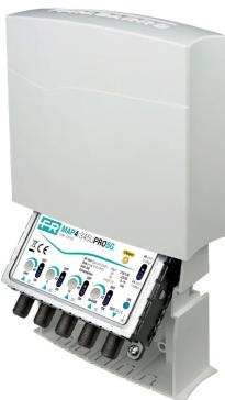
Amplificador de mástil con 3 entradas (III+DAB, UHF, UHF) con ganancia de 40 dB y nivel de salida de hasta 110 dB $\mu$ V o 120 dB $\mu$ V en la banda UHF seleccionable, amplificación independiente de VHF/UHF, ajustes de ganancia independientes (0-15 dB) para cada entrada y baja figura de ruido. Filtro 5G de 694 MHz integrado.
