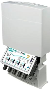
Amplificador de mástil con una entrada (III+DAB+IV+V) con una ganancia de 41 dB y un nivel de salida de hasta 110 dB $\mu$ V o 120 dB $\mu$ V en banda UHF seleccionable, amplificación independiente de VHF/UHF, ajustes de ganancia independientes (0-15 dB) para cada banda y baja figura de ruido. Filtro 5G de 694 MHz integrado.
