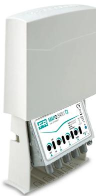
Amplificador de mástil con 3 entradas (III+DAB, UHF, UHF) con ganancia de 28 dB y nivel de salida de hasta 116 dB $\mu$ V en la banda UHF, amplificación independiente VHF/UHF, ajustes de ganancia independientes (0-15 dB) para cada entrada y baja figura de ruido. 2 salidas y filtro integrado para 5G y 4G LTE de 694 MHz.
