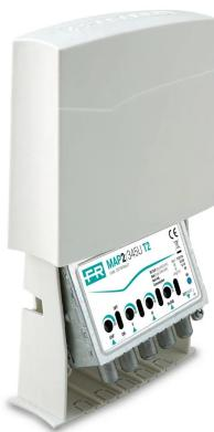
**Amplificateur de mât à 3 entrées (III+DAB, UHF) avec gain de 28dB et niveau de sortie jusqu'à 116dB $\mu$ V en bande UHF, amplification VHF/UHF séparée, réglage de gain indépendant (0-15dB) pour chaque entrée et faible facteur de bruit. 2 sorties et filtre 5G et 4G LTE 694MHz intégré.**
