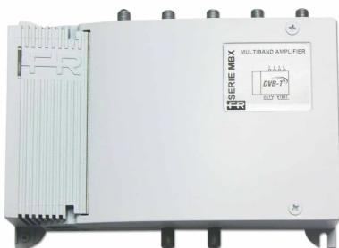
Unidad central autoamplificada de interior con 1 entrada (RC+VHF+UHF+SAT) con ganancia de 45dB y nivel de salida hasta 127dB $\mu$ V en la banda UHF, ajuste independiente de ganancia y pendiente (20dB) en las bandas de TV y SAT y baja figura de ruido.
