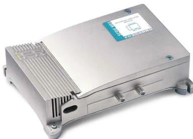
**Unidad central autoamplificada de interior con 2 entradas (VHF+UHF, SAT) con ganancia de 40dB y nivel de salida hasta 125dB $\mu$ V en la banda SAT, ajuste de ganancia (20dB) y baja figura de ruido.**
